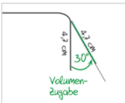
Anschliessend übertragt ihr die Länge des Bügels (ab dem Punkt, von dem ihr ausgestellt habt) auf die neue, ausgestellte Linie, indem ihr den Taschenbügel links und rechts um den Eckpunkt dreht. Übertragt den Endpunkt des Bügels auf die neue Linie.
